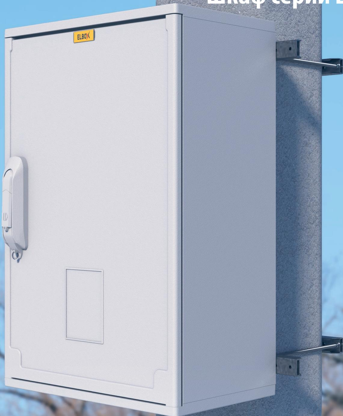
Изделия серии EP имеют плоскую крышу, а серии EPV — наклонную крышу и антивандальное исполнение для установки на открытом воздухе. Элементы фундамента легко снимаются без применения инструментов, что позволяет легко организовать ввод кабеля. При толщине стенки в три раза большей, чем у элементов из стали, элементы из полиэстера значительно легче.
