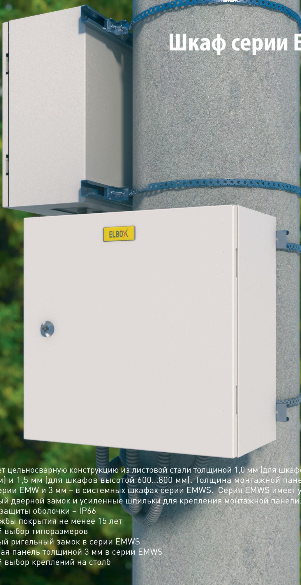
Корпус имеет цельносварную конструкцию из листовой стали толщиной 1,0 мм (для шкафов высотой 300...500 мм) и 1,5 мм (для шкафов высотой 600...800 мм). Толщина монтажной панели 2,5 мм в шкафах серии EMW и 3 мм – в системных шкафах серии EMWS. Серия EMWS имеет усиленный трёхточечный дверной замок и усиленные шпильки для крепления монтажной панели.
